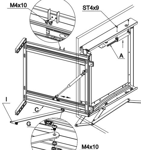
**7** Установить регулировочную штангу **I** в держателе на фасаде и закрепить пластиковым фиксатором. Отрегулировать фасад при помощи регулировочной штанги. Установить 2 корзины **J** на боковую раму **C**. Установить 2 корзины **K** на заднюю раму **B**.
