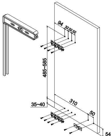
**1** Закрепить заднюю раму **B** на боковой и задней стенках шкафа.
