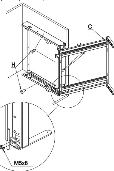
**6** Зафиксировать винтами фиксатор в верхней части рамы и закрепить доводчик **A** на боковой раме **C**. Закрепить регулировочную штангу **I** на раме винтами **G**.
