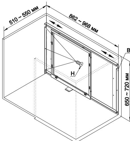
**2** Отметить линию на дне и боковой стенке шкафа на расстоянии 7 мм от края передней кромки, боковую раму **C** в закрытом положении выровнять крайнюю точку **O** с отмеченной линией.
