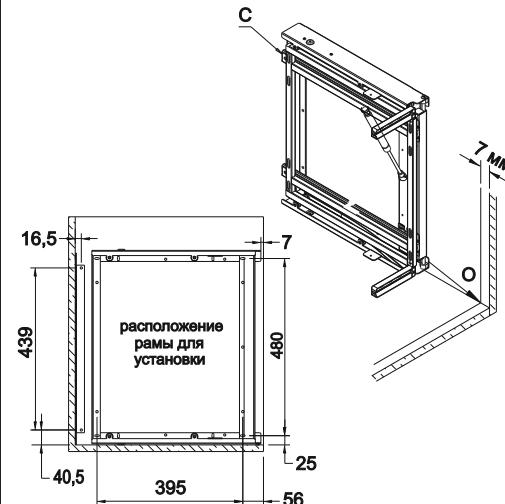
**3** Выдвинуть боковую раму **C** в открытое положение, закрепить её к боковой стенке и дну шкафа саморезами **H**.
