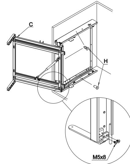
**6** Зафиксировать винтами фиксатор в верхней части рамы и закрепить доводчик **A** на боковой раме **C**. Закрепить регулировочную штангу **I** на раме винтами **G**.
