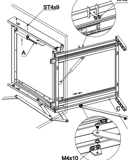
**7** Установить регулировочную штангу **I** в держателе на фасаде и закрепить пластиковым фиксатором. Отрегулировать фасад при помощи регулировочной штанги. Установить 2 корзины **J** на боковую раму **C**. Установить 2 корзины **K** на заднюю раму **B**.
