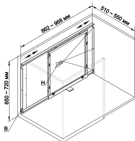
**2** Отметить линию на дне и боковой стенке шкафа на расстоянии 7 мм от края передней кромки, боковую раму **C** в закрытом положении выровнять крайнюю точку **O** с отмеченной линией.
