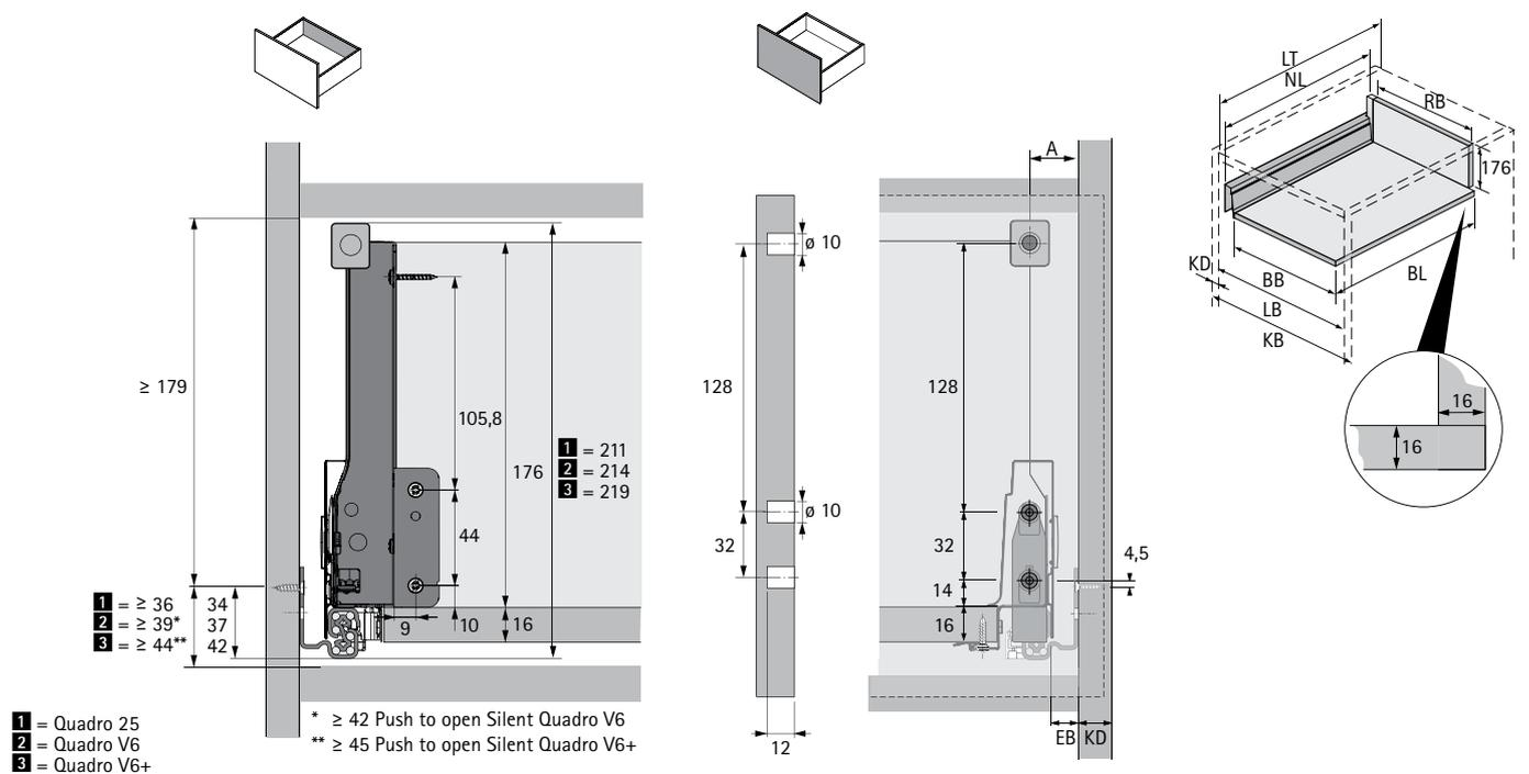
Возможен монтаж дополнительного релинга на расстоянии 64 или 54,5 мм ниже верхнего релинга.
