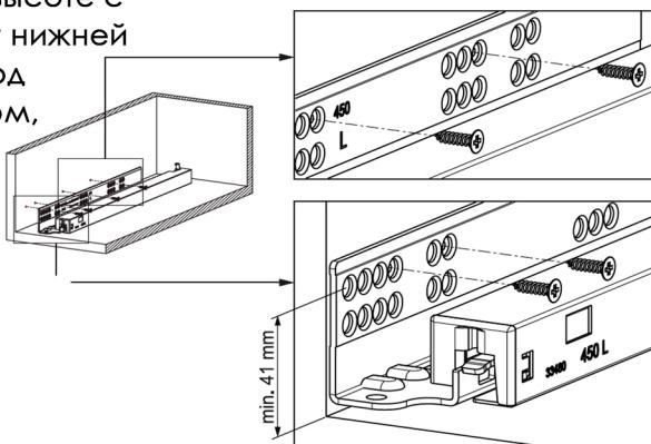
1. Установите замки(в комплекте поставки) во внутренних углах ящика со стороны дна.
