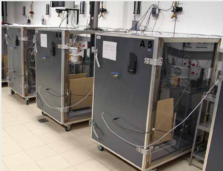
Испытательные камеры объемом 1 м 3 , установленные во Фраунгоферском институте по исследованию древесины им. Вильгельма Клаудица.
